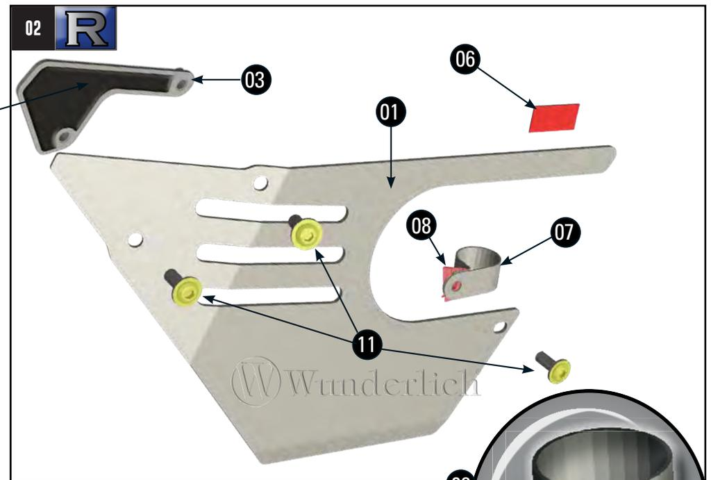
**!** Alle anliegenden Teile mit Moosgummi oder Lack-schutzfolie bekleben wie abgebildet!
