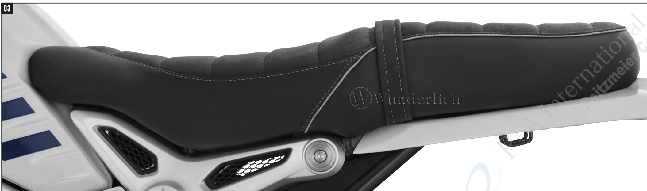
Sitzbank vorne in die 2 Führungbolzen einschieben und hinten wieder verschrauben. Insert the seat in the front of the 2 guide bolts and screw the seat back on again.
