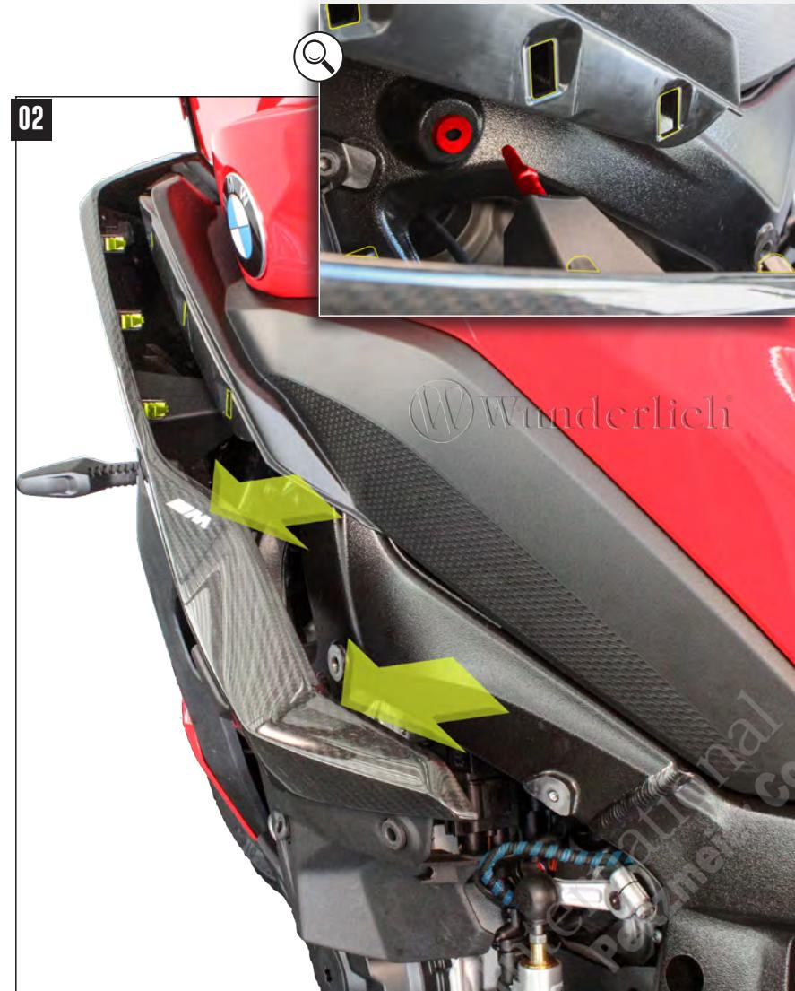
**JETZT ZIEHEN SIE DIE SEITENVERKLEIDUNG, WIE AUF DEM BILD GEZEIGT, VORSICHTIG AUS DEN VERKLEIDUNGSCLIPS. DIE SEITENVERKLEIDUNG MUSS NICHT KOMPLETT DEMONTIERT WERDEN.**
