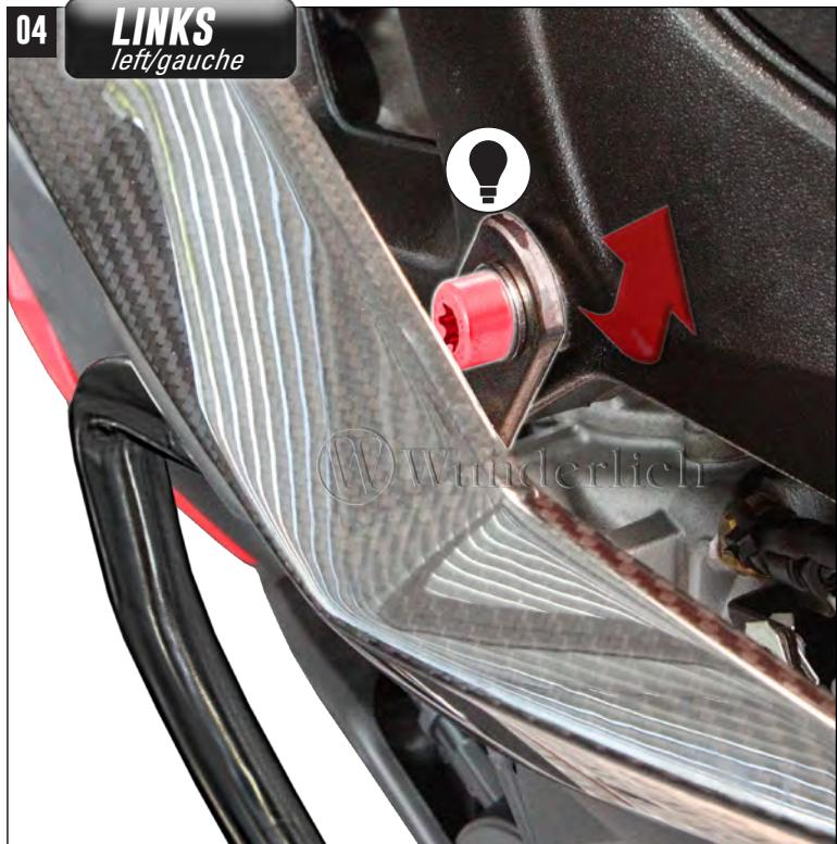
**FÜHREN SIE DEN BÜGEL MIT DER OBEREN LASCHE VON UNTER HINTER DIE SEITENVERKLEIDUNG UND MONTIEREN DIESE LOSE. DRÜCKEN SIE DAS UNTERE ROHRENDE IN DIE VORHER MONTIERTE HÜLSE.**
