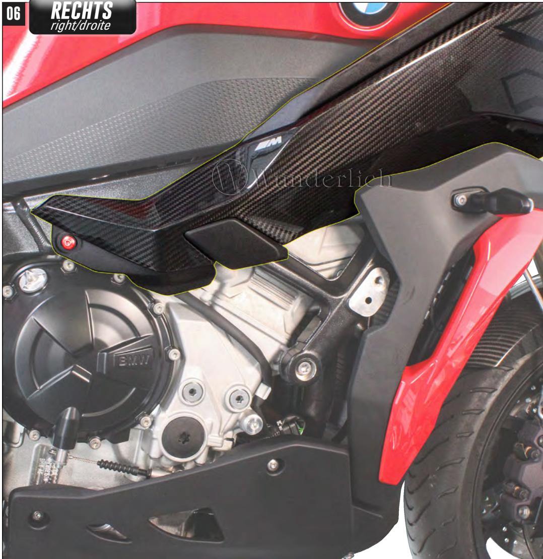
**DIE MONTAGE DER RECHTEN SEITE IST IDENTISCH. EINIGST DIE SEITENVERKLEIDUNG IST NUR MIT EINER SCHRAUBE BEFESTIGT.**
