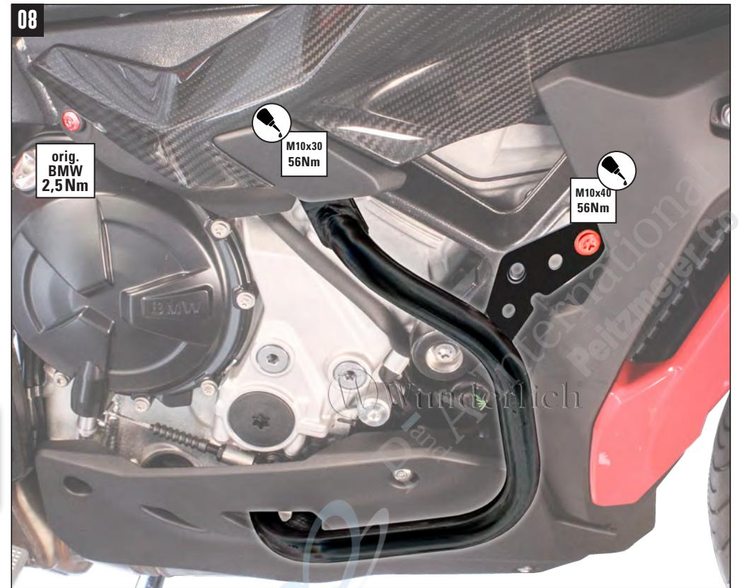
**Montage der originalen Zusatzscheinwerfer am Motorschutzbügel. Halter und Scheinwerfer einstellen.**
