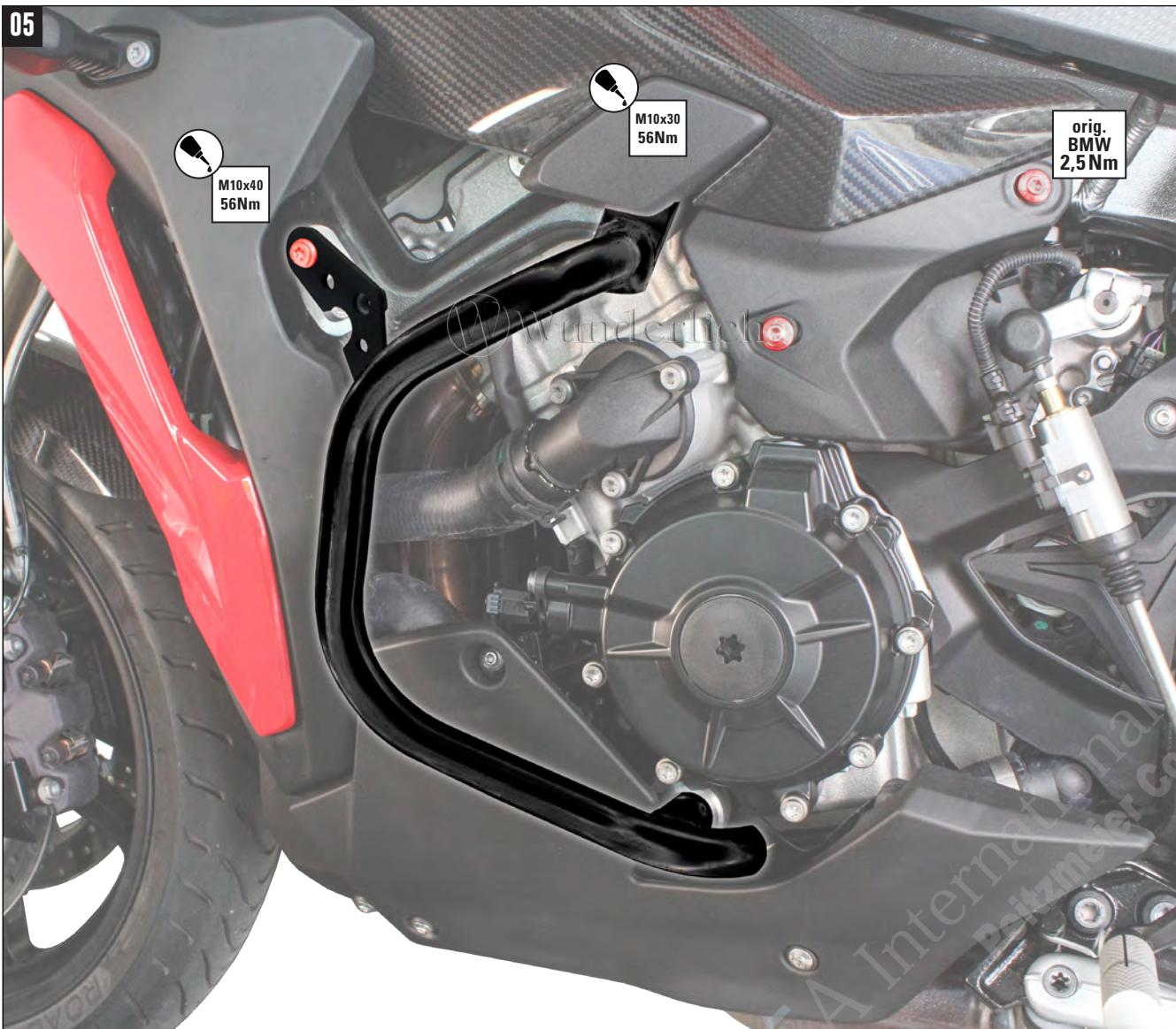
**VORDEREN BEFESTIGUNGSPUNKT MONTIEREN UND BEIDE MIT DEM ANGEgebenEN DREHMOMENT ANZIEHEN. SEITENVERKLEIDUNG IN UMGEKEHRTER REIHENFOLGE BEFESTIGEN.**
