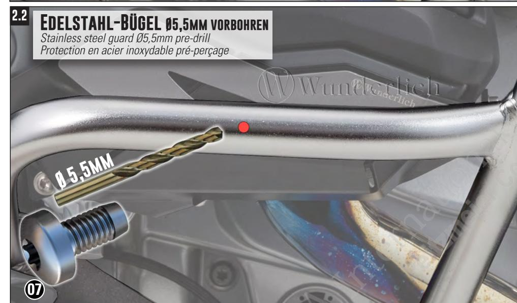
**WIR EMPFEHLN FÜR DEN ARBEITSSCHRITT „BOHREN“, DEN STURZBÜGEL ZU DEMONTIEREN. IM MONTIERTEM ZUSTAND BOHREN, SCHÜTZEN SIE DEN DAHINTER LIEGENDEN MOTOR BZW. DIE VENTILDECKEL.**
