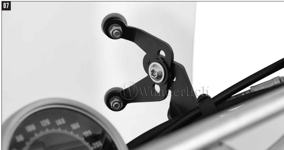
**Je nach Toleranzen und Ausrichtung der Grundhalter, können die Scheibhalter optional von aussen oder innen am Grundhalter montiert werden.**
