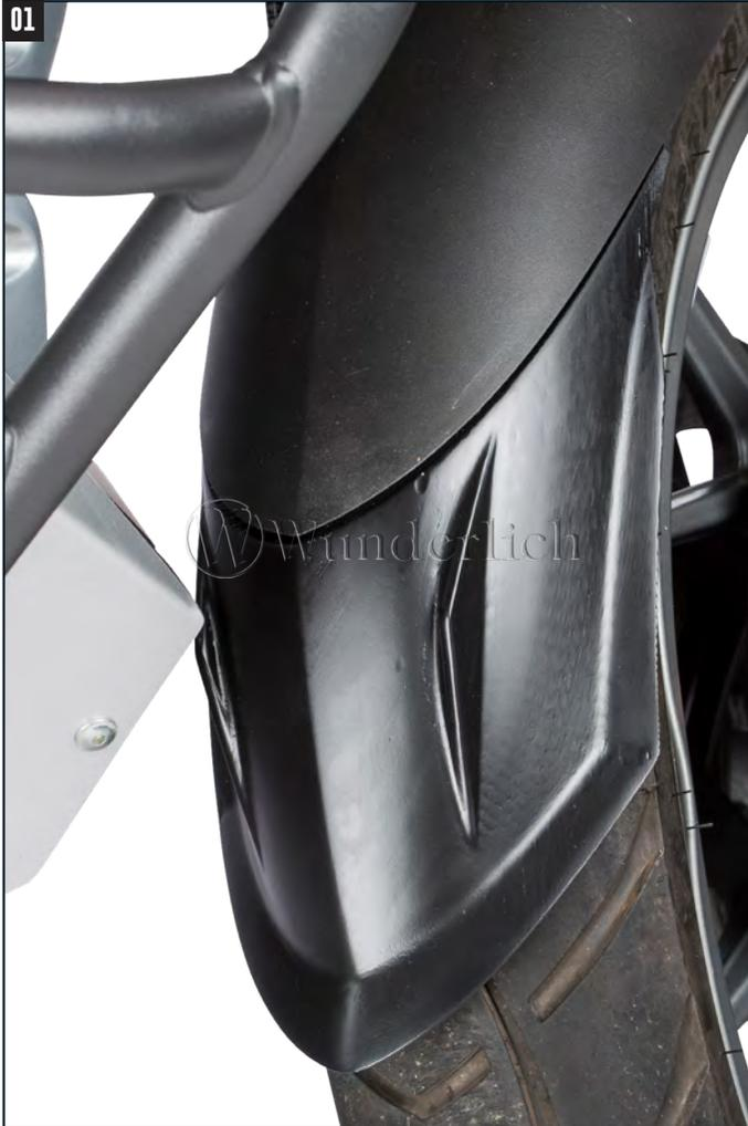
Probeweise sollten Sie zunächst den Extenda-Fender (ohne die Klebefolie zu entfernen) am Kotflügel anhalten. Kleben Sie den Extenda-Fender nun mittig unter den Kotflügel, so dass er möglichst paßgenau ansitzt. *Place the extender up to the guard as a trial fit before removing the backing tape. Make sure it is fitted "square" to the guard, firmly pressing it to the fender. Apply finger pressure to the sides to fully seat it against the guard.*
