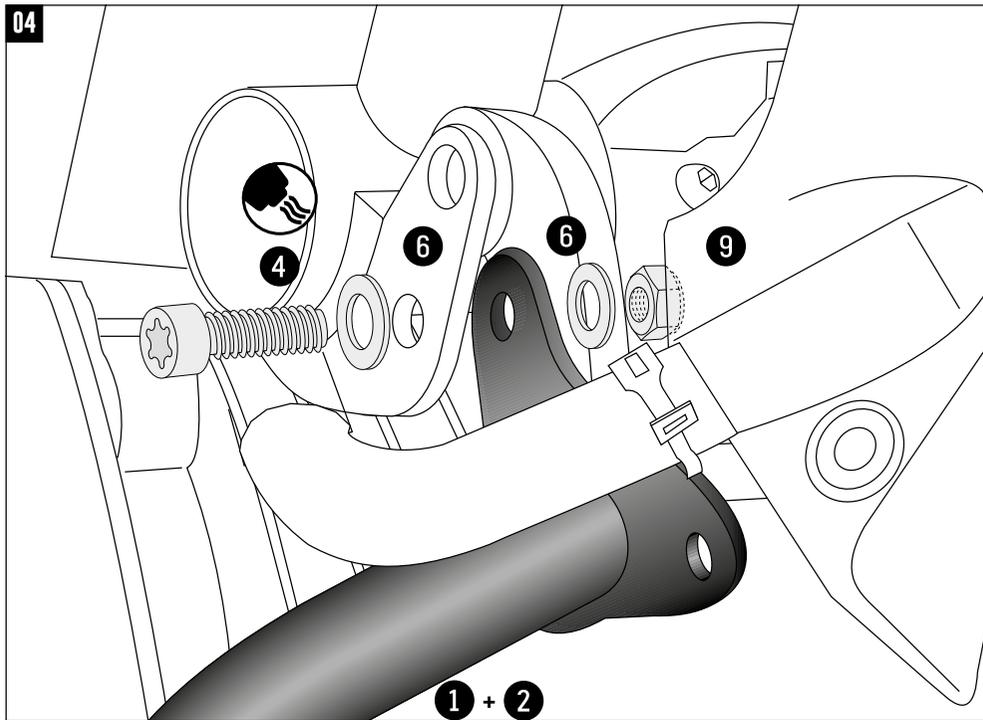
**Montage des Motorschutzbügels oben rechts/links:**
