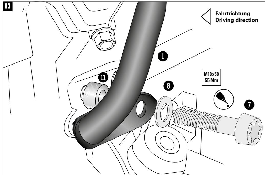
**Montage des Motorschutzbügels hinten links:**
