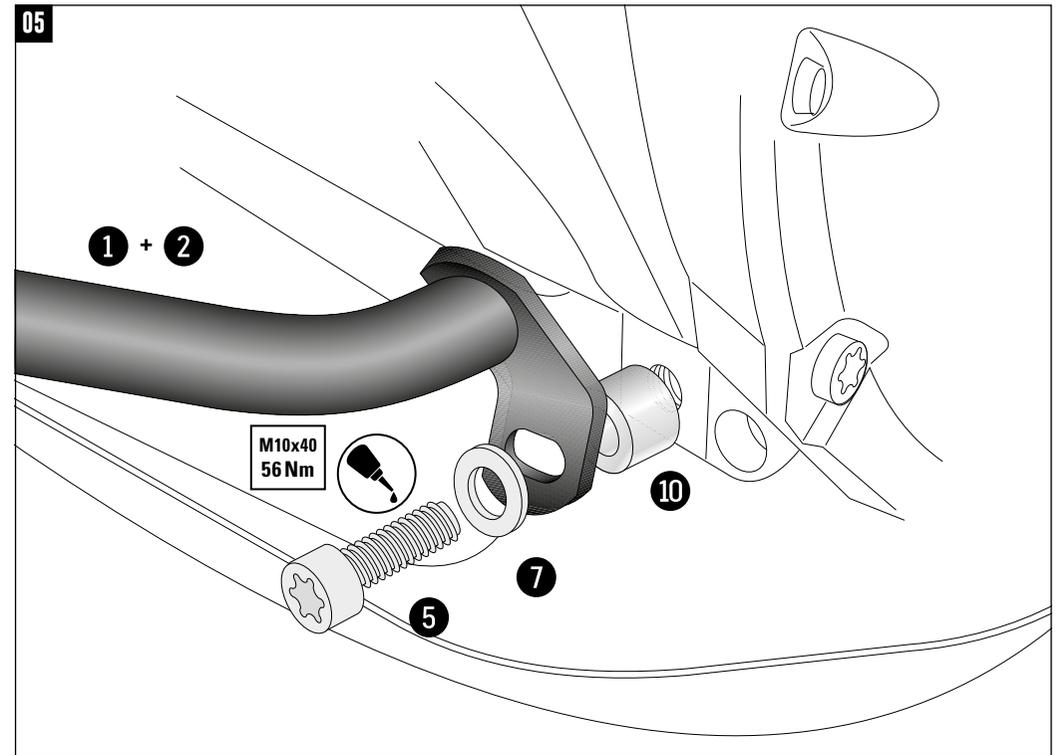
**Montage des Motorschutzbügels vorne unten rechts/links:**
