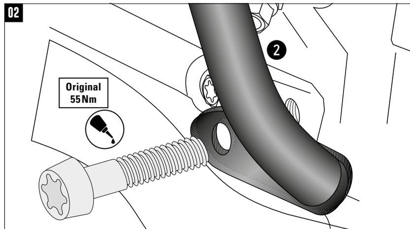
**Montage des Motorschutzbügels hinten rechts:**
