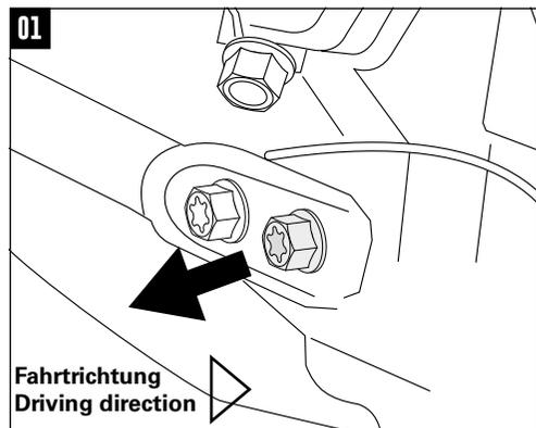
Bild 1: Vor Montage der jeweiligen Seite muss die vordere Schraube der unteren Rahmenbefestigung entfernt werden, die der linken Seite entfällt.
