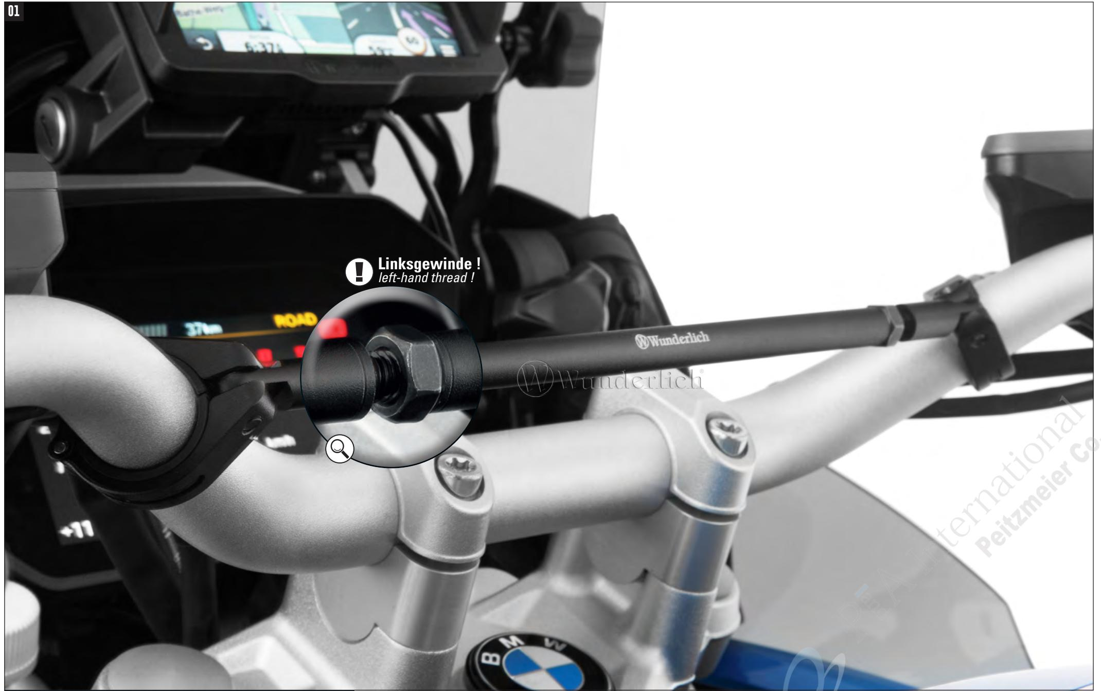
**Lenkerstrebe zentrieren, Klemmschellen montieren und danach die Mittelstrebe fixieren (Mutter Rechts- / Linksgewinde).**
