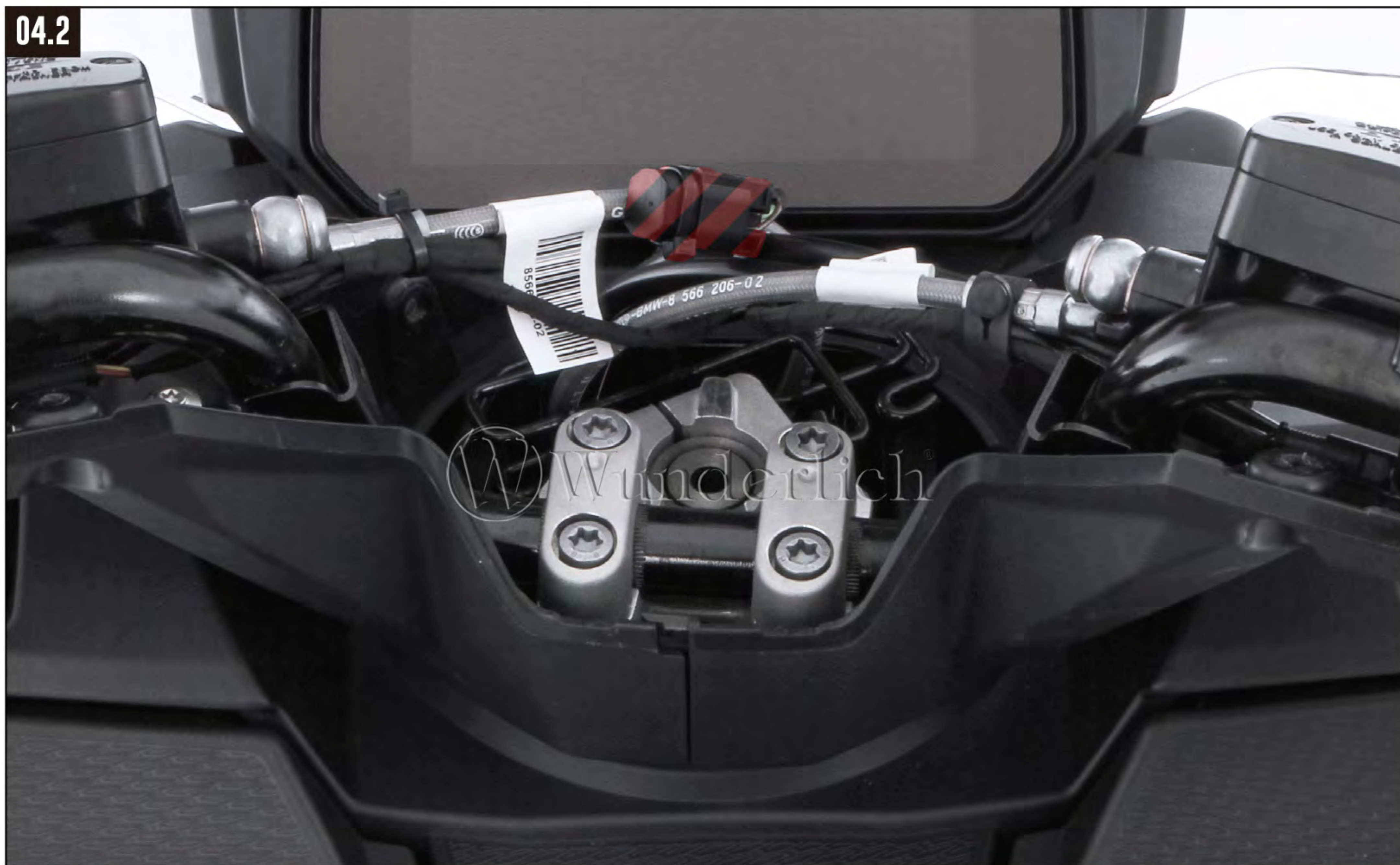
ANSCHLUß ORIGINAL NAVI. Connection of original navigation system. Connexion système de navigation d'origine.
