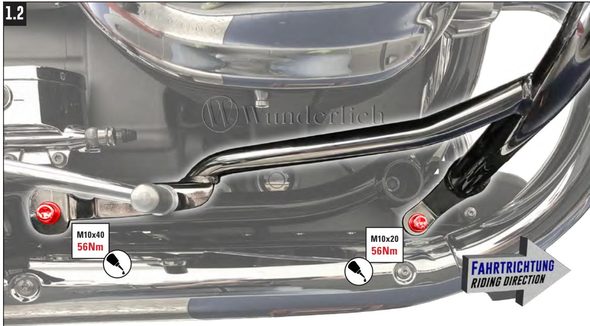
ZUR MONTAGE VORNE OBEN, MUSS MODELLABHÄNGIG DER LENKUNGSDÄMPFER GELÖST WERDEN (AUF DIE RICHTIGE POSITION DER MOOGGUMMISCHEIBE UND STUFENHÜLSE ACHTEN). MOTORSCHUTZ LOCKER VORMONTIEREN, AUSRICHTEN UND ZULETZT DIE SCHRAUBEN MIT ANGEgebenEN DREHMOMENT ANZIEHEN.
