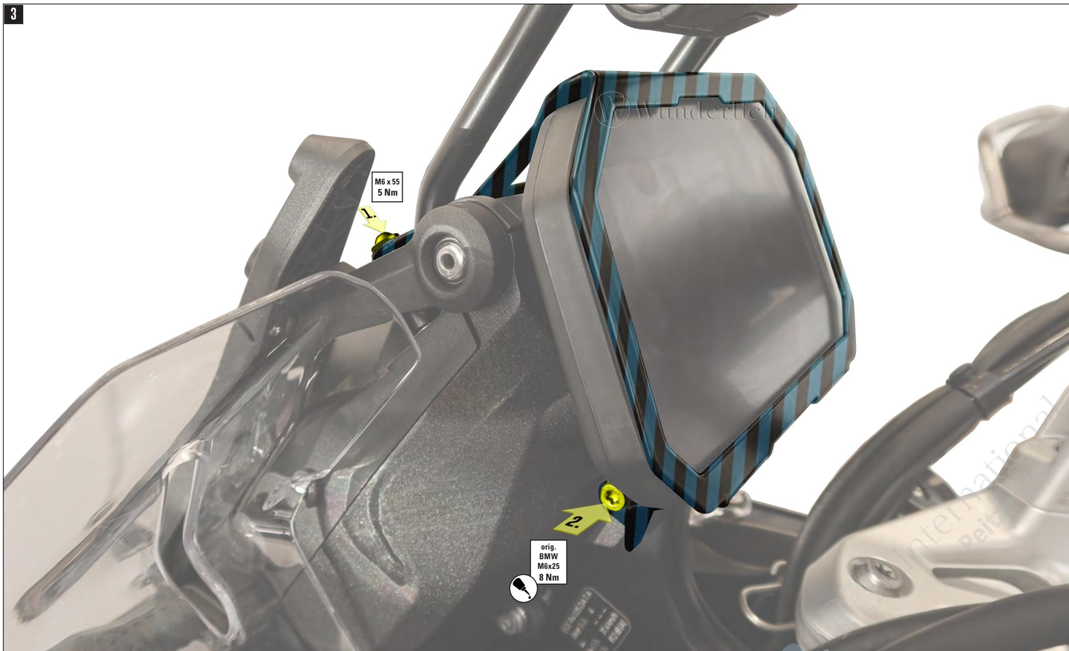
**DIE BEIDEN OBEREN ORIGINALEN SCHRAUBEN DES FRONTRÄGERS DEMONTIEREN. DISPLAYSCHUTZ DER REIHE NACH MONTIEREN.**
