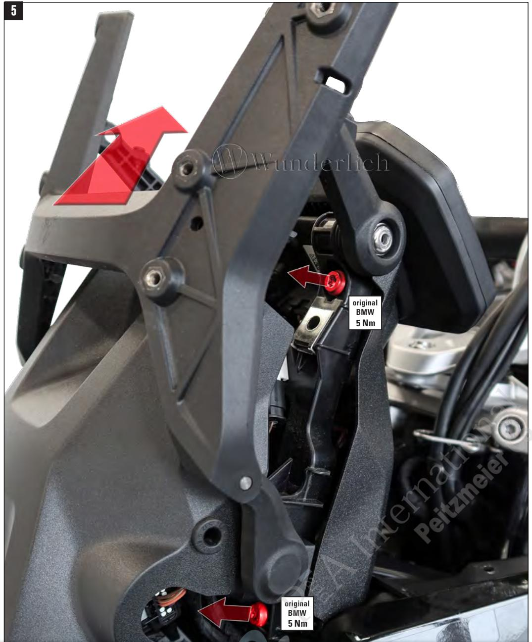
**ABDECKUNG DER WINDSCHILDVERSTELLUNG LÖSEN BZW. NAVI HALTER DEMONTIEREN (BILD2). WINDSCHILDHALTER IN DIE OBERSTE POSITION BRINGEN UND DIE SCHRAUBEN DES GRUNDHALTER DEMONTIEREN (BILD3).**
